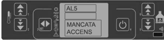
44. pannello comandi - allarme mancata accensione
