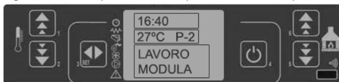
34. pannello comandi - modulazione temperatura impostata
