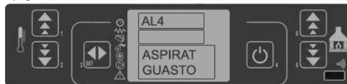
43. pannello comandi - allarme ventilatore aspirazione fumi
