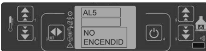
44. panel de mandos - alarma fallo de encendido
