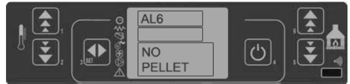
45. panel de mandos - alarma apagado durante funcionamiento
