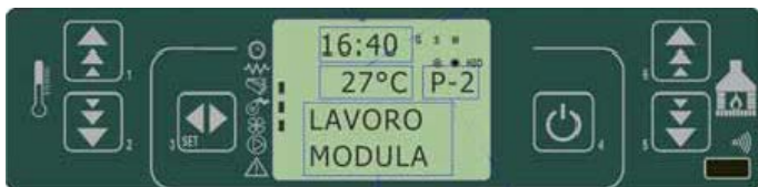
fig. 30 pannello comandi - modulazione temperatura impostata
