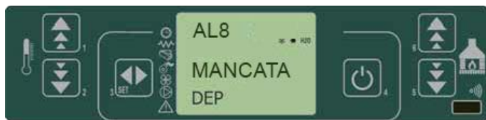
fig. 41 panel de mandos - alarma presostato de seguridad del tornillo sin fin
