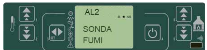
fig. 37 panel de mandos - alarma de la sonda temperatura de humos
