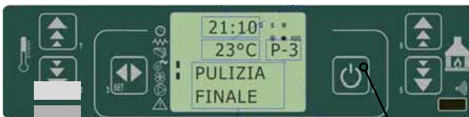
fig. 32 panel de mandos - limpieza final
