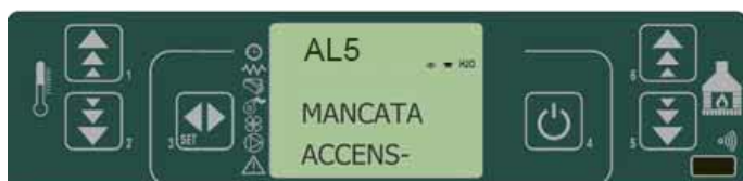
fig. 39 panel de mandos - alarma fallo de encendido
