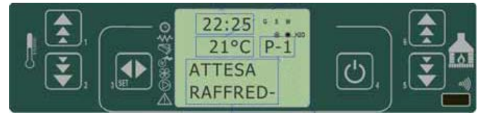
fig. 34 panel de mandos - espera enfriamiento antes de volver a encenderse
