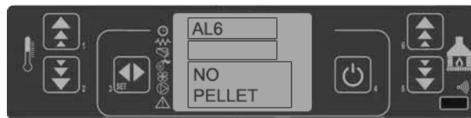
46. panel de mandos - alarma apagado durante funcionamiento
