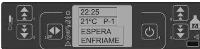
39. panel de mandos - espera enfriamiento antes de volver a encenderse
