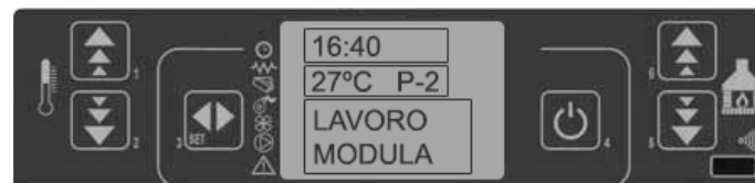
36. pannello comandi - modulazione temperatura impostata
