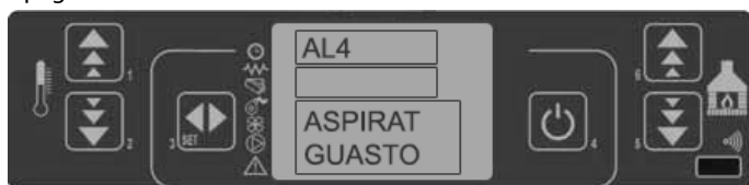
45. pannello comandi - allarme ventilatore aspirazione fumi
