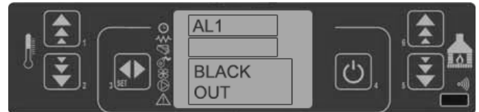
41. panel de mandos - interrupción de suministro de energía eléctrica
